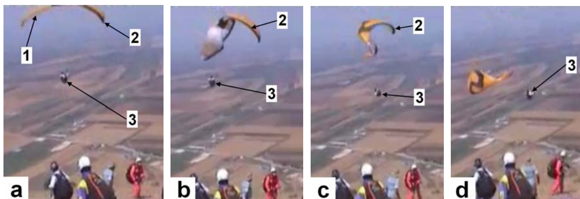
Bildfolge 23 eines echten großflächigen seitlichen Einklappers– a: beginnender Einklapper, b: Ende Geradeausphase, c: Ende Drehphase, d: Ende Vorschießphase; 1 Beginnender Einklapper (linke Kappenseite), 2 Hinterkante der offenen Kappenseite (schwarz), 3 Pilot
